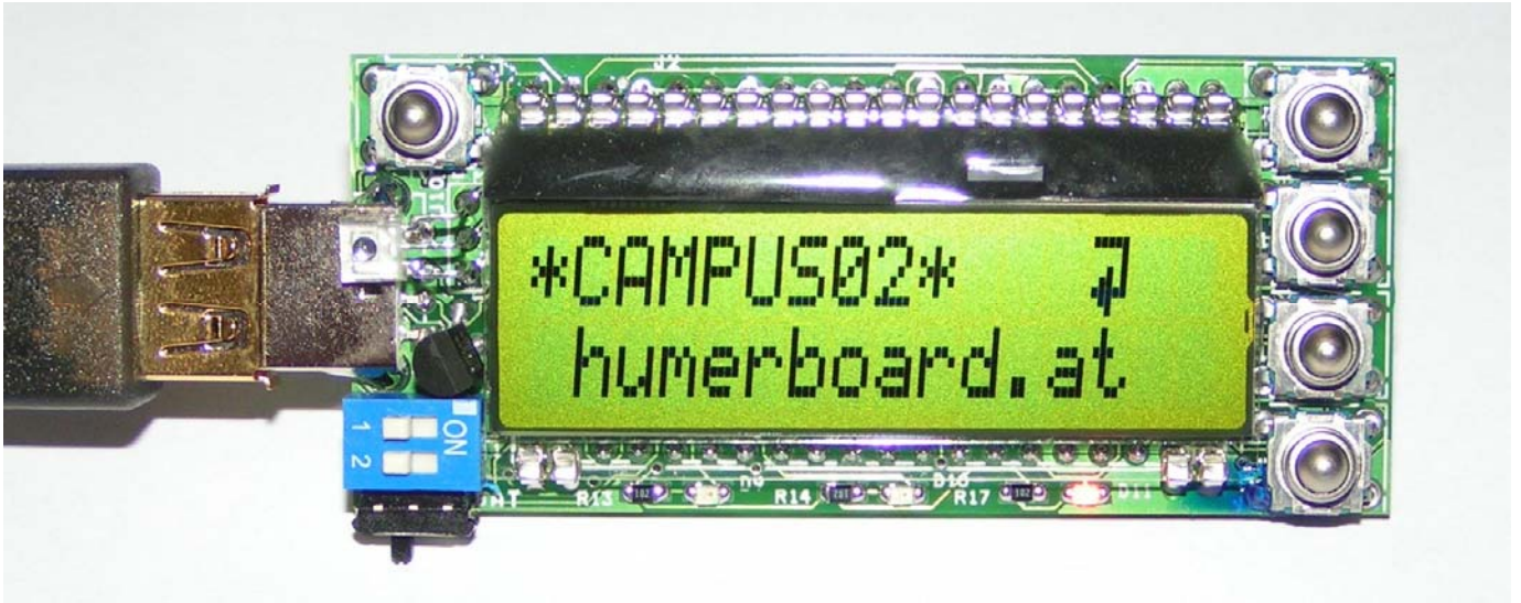
Abb.: Fertiges, voll bestücktes Microcontrollerboard NLB ADUC831
